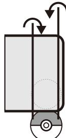
②収納カバーの幅に収まるように右端10cm程度残し、左から右に折り畳み、右端10cmを右から左に折り畳み被せてください。
